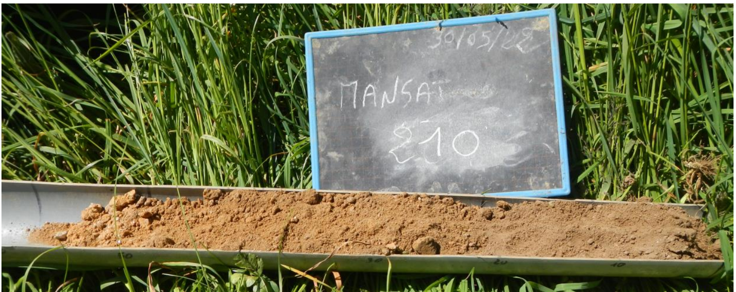
Photo 1 : sondage 210, exemple de brunisol dystrique humifère, pachique, issu de colluvions, chargé en éléments grossiers sur leucogranite du plateau de Millevaches - Site des Bruges 23400 Mansat La Courrière ; 2022
